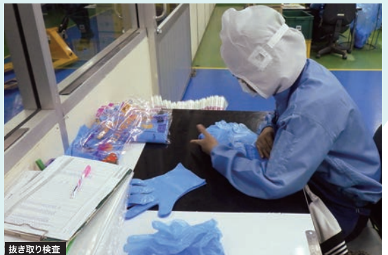
抜き取り検査
